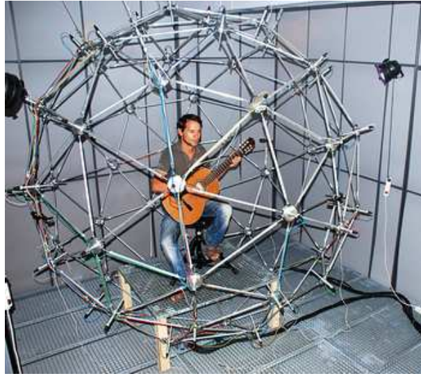
Figure 40 – Kugelförmige Mikrofonanordnung zur Messung der Schallabstrahlung.
