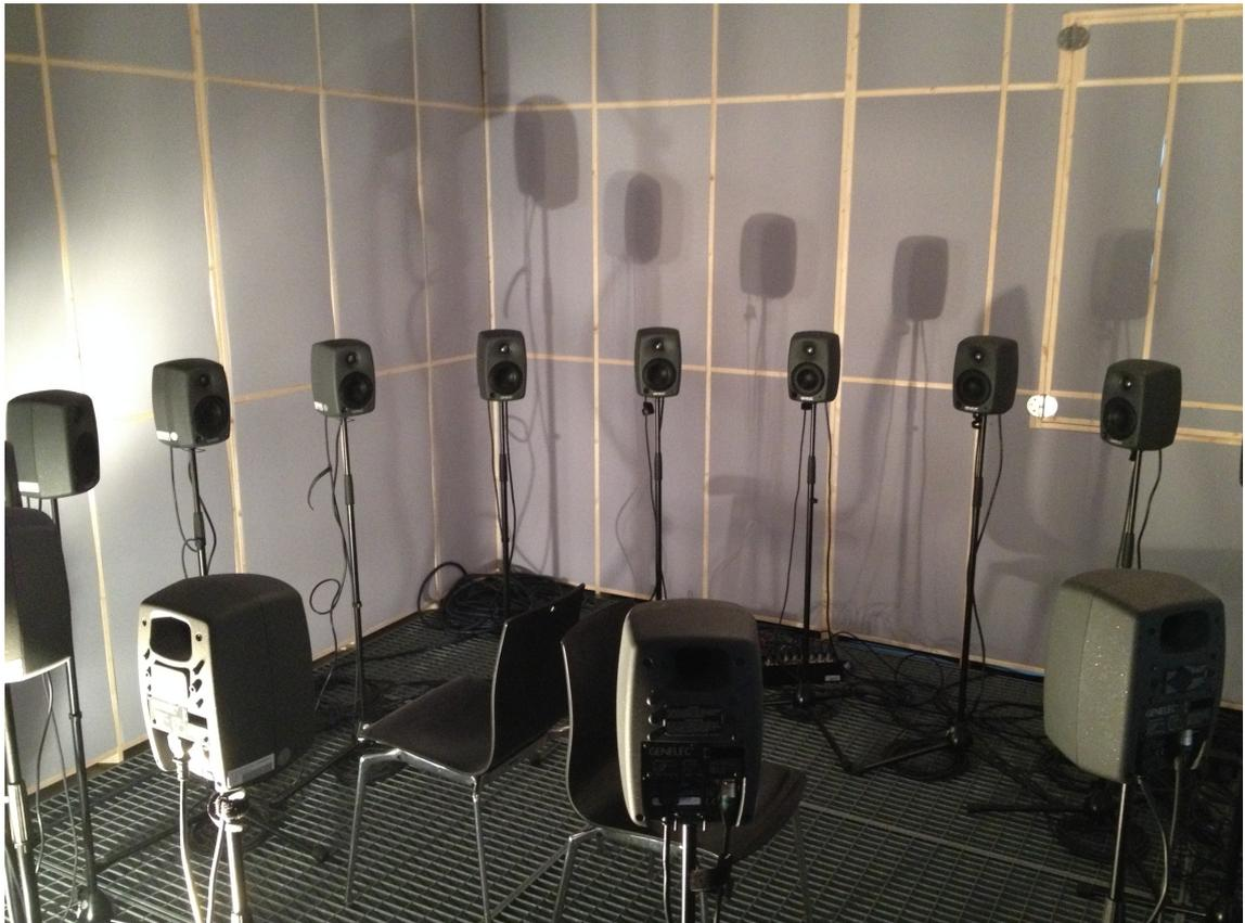
Abbildung 4: Aufbau der Lautsprecher bei den Hörversuchen.
