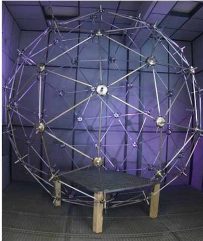
Abbildung 3: Mikrofonkugelarray des IEM [Hoh09]
