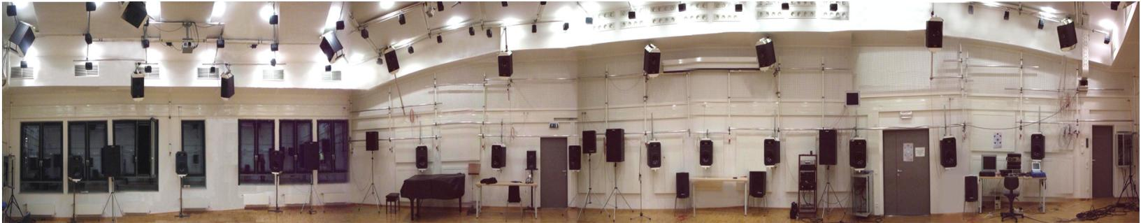
SH-zerlegter Schalldruck wird an den Lautsprechern diskret rekonstruiert.
