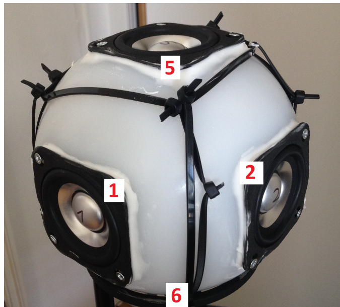
Abbildung 6: Anordnung der Lautsprecher auf der Kugel. LS 1-4 sind gegen den Uhrzeigersinn angeordnet (LS 3-4 sind nicht sichtbar).
