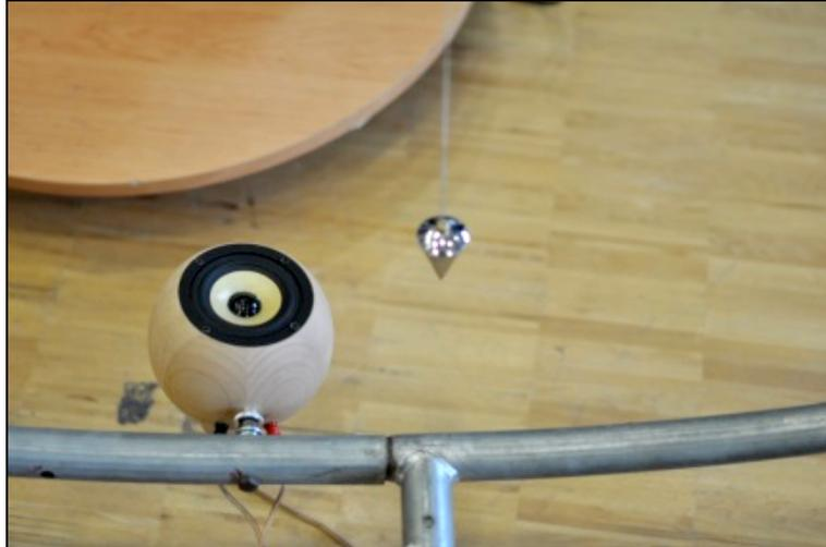
Abb. 2.2: Ausrichten des Aufbaus mittels Lot
