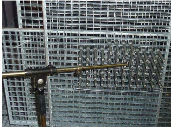
Abbildung 10: Messaufbau für akustische Nahfeldholographie
