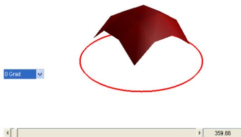
Abbildung 4: Wellenzahlspektrum der Punkt-schallquelle  $0^\circ$  vor dem Array bei 360 Hz
