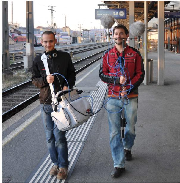
Abbildung 1: Aufnahme mit beiden Mikrofonarrays, Eigenmike (links) und Soundfield (rechts), am Grazer Hauptbahnhof.
