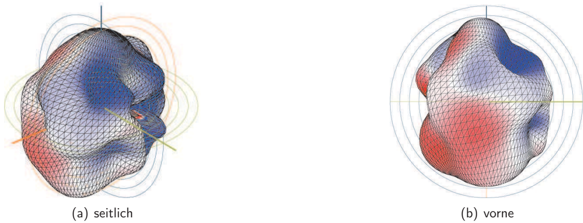
Abbildung 5.25: Anblasloch der Querflöte im Ursprung, 1. Teilton von c^{(2)} (533 Hz), nicht überblasen, 30 dB-Bereich
