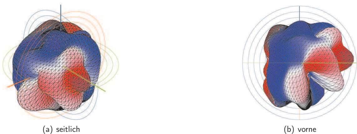
Abbildung 5.10: Ende der Querflöte im Ursprung, 1. Teilton von g^{(2)} (802 Hz), 30 dB-Bereich
