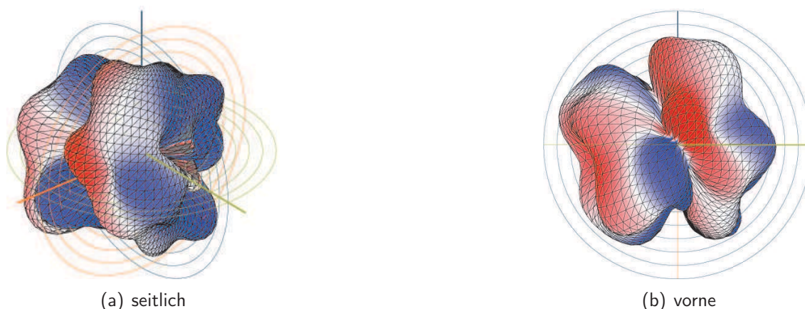
Abbildung 5.24: Anblasloch der Querflöte im Ursprung, 1. Teilton von a^{(2)} (888 Hz), forte, 30 dB-Bereich
