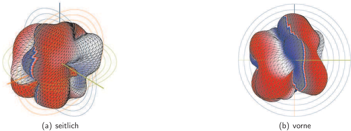
Abbildung 5.8: Anblasloch der Querflöte im Ursprung, 1. Teilton von g^{(2)} (802 Hz), 30 dB-Bereich
