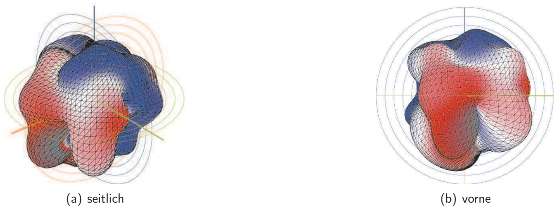
Abbildung 5.9: Mitte der Querflöte im Ursprung, 1. Teilton von g^{(2)} (802 Hz), 30 dB-Bereich
