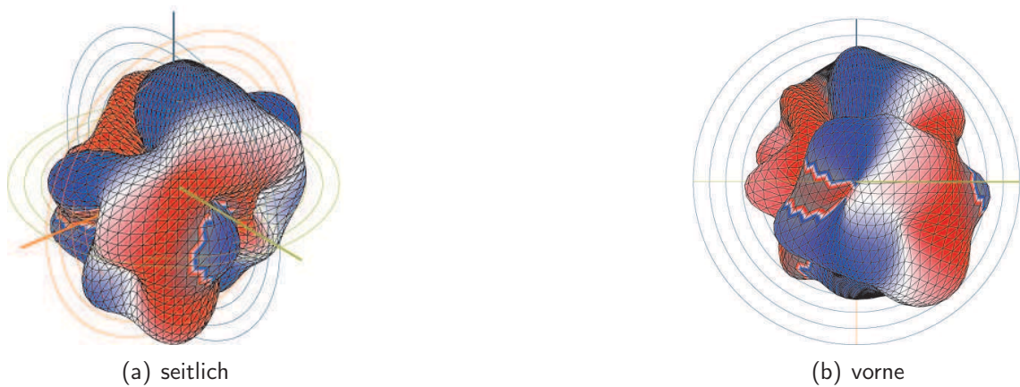
Abbildung 5.7: Ende der Querflöte im Ursprung, 1. Teilton von c^{(2)} (533 Hz), 30 dB-Bereich
