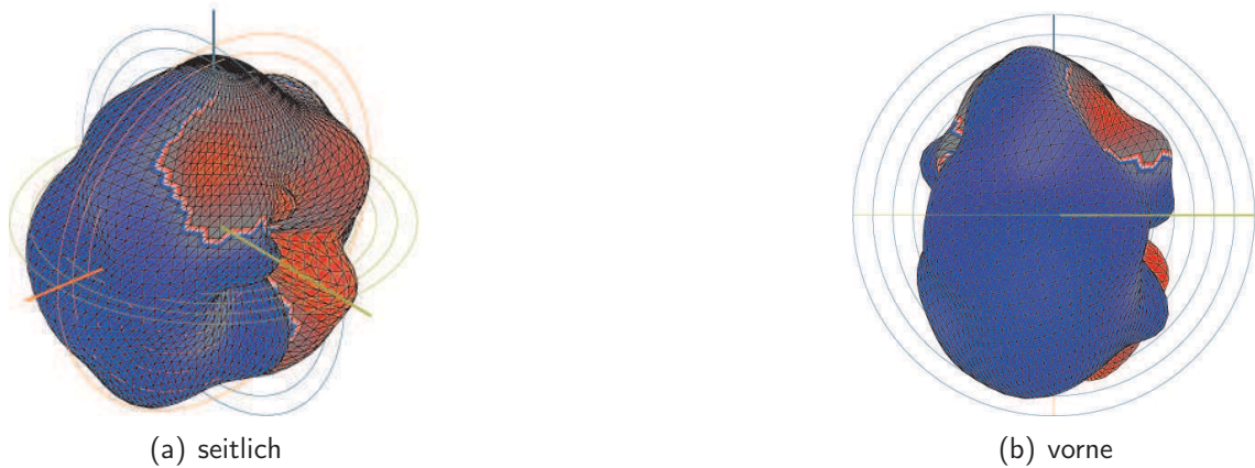
Abbildung 5.5: Anblasloch der Querflöte im Ursprung, 1. Teilton von c^{(2)} (533 Hz), 30 dB-Bereich
