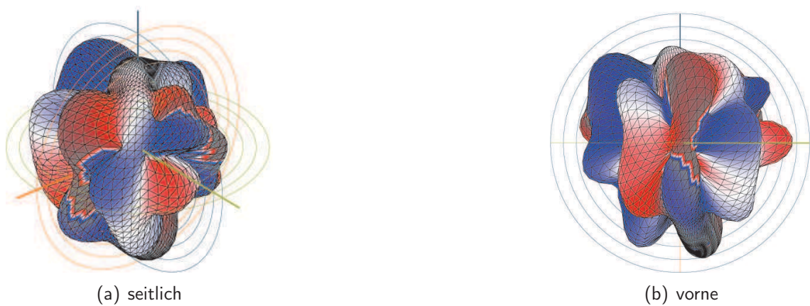
Abbildung 5.13: Ende der Querflöte im Ursprung, 1. Teilton von c^{(3)} (1071 Hz), 30 dB-Bereich
