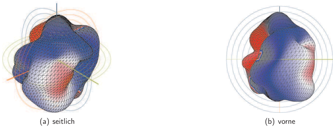
Abbildung 5.6: Mitte der Querflöte im Ursprung, 1. Teilton von c^{(2)} (533 Hz), 30 dB-Bereich
