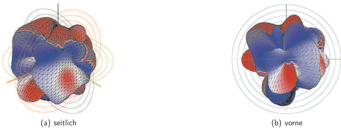
Abbildung 5.12: Mitte der Querflöte im Ursprung, 1. Teilton von c^{(3)} (1071 Hz), 30 dB-Bereich
