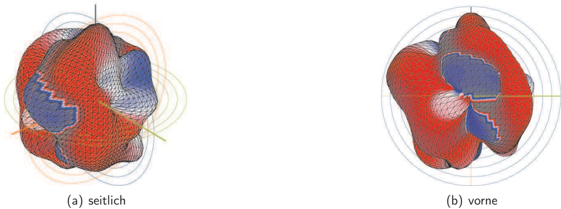
Abbildung 5.11: Anblasloch der Querflöte im Ursprung, 1. Teilton von c^{(3)} (1077 Hz), 30 dB-Bereich
